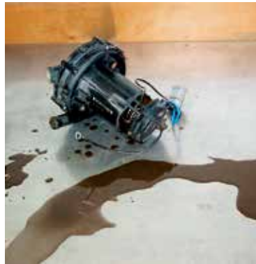
示意图28: 冷凝水 - 二次进气泵
