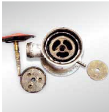
示意图30: 断路式止回阀隔膜和气门顶损伤 (由于冷凝水)
