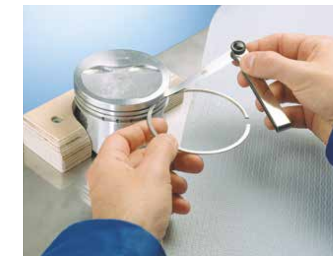
用塞尺测量活塞环槽： KS 商品编号 50 009 824
