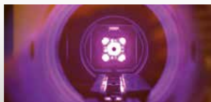
喷镀轴瓦的内腔：在高真空环境下借助气体离子提高轴瓦最上层的质量。
