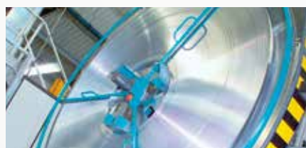
基层材料：三元金属轴瓦的高质生产材料。
