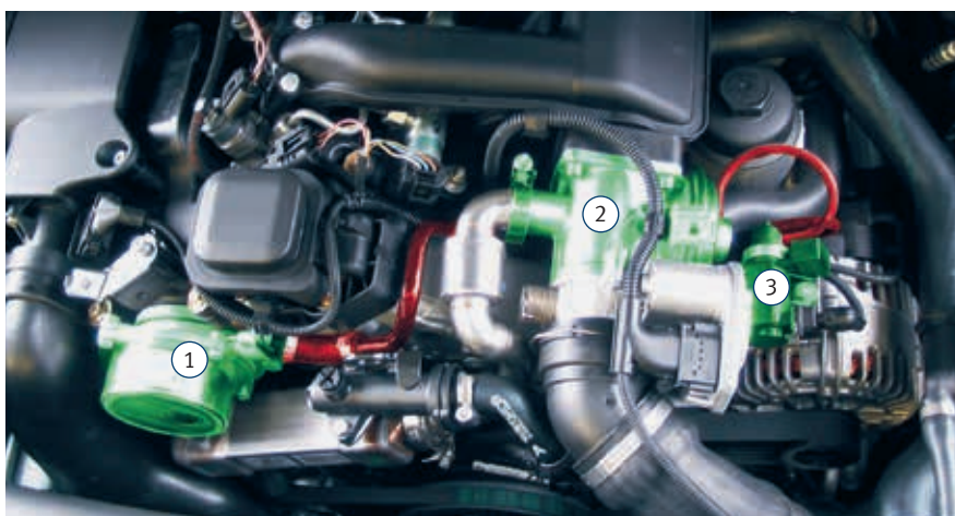
Пример BMW 118d (E87): детали вакуумной системы (зеленого цвета), вакуумные шланги (красного цвета)
