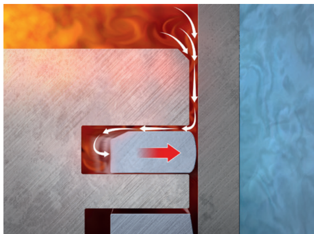
Рис. 1. Увеличение усилия прижатия за счет давления сгорания
