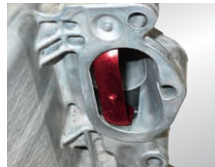
Перекидная заслонка (выделена красным цветом) для режима послынного заряда
