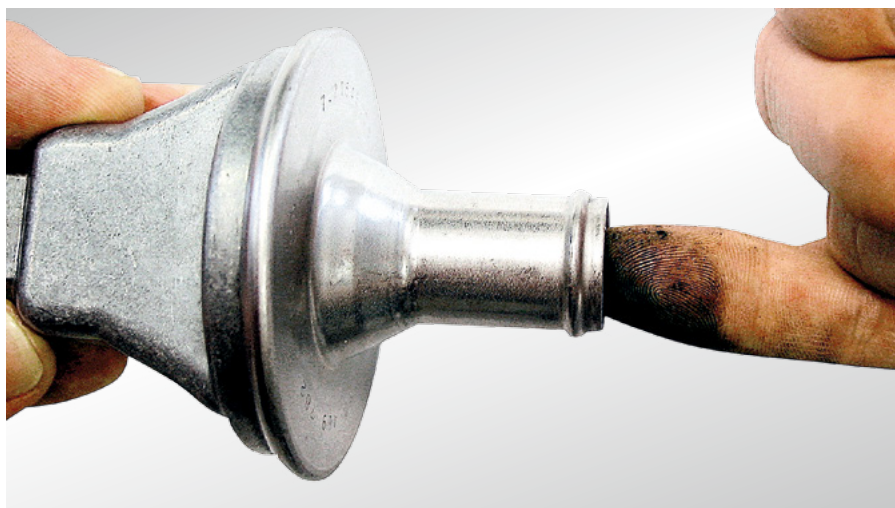
Рис. 32 Простая проверка обратного клапана
