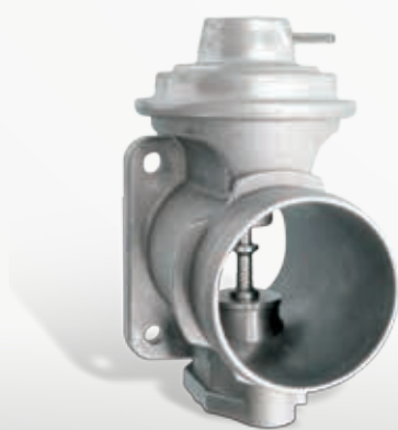
Испытаны временем: пневматические клапаны системы EGR.
