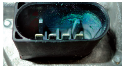
Разъём на корпусе заслонки со следами коррозии
