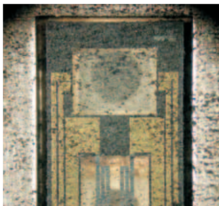
Соль и грязь могут повредить датчик сенсора воздушных масс – по меньшей мере, однако, они фальсифицируют их измерения, что снова может повлиять на рециркуляцию отработавших газов.
