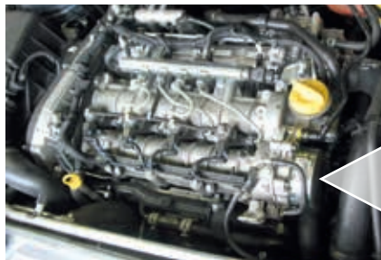
Пример: у Opel Vectra смазочное масло подается через отверстия во фланце.
