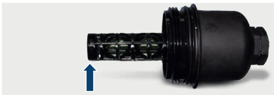
Рис. 2: Место излома пластмассовой трубы, отсутствует затвор для дренажного клапана
