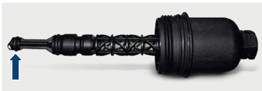
Рис. 1: Пластмассовая труба на крышке масляного фильтра (МВ OM611, OM646, M271) Подробность: Затвор дренажного клапана — сухарь с уплотнительным кольцом
