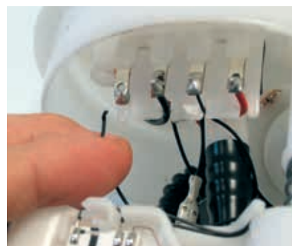
Рис. 3: типичная картина повреждения: кабель датчика давления в топливном баке оторван, а электрические контактные выступы погнуты.
