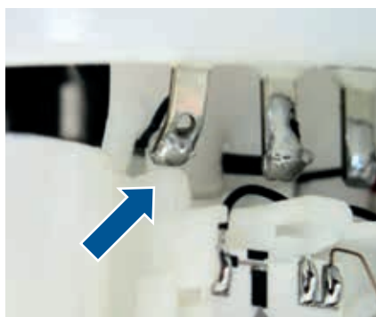
Рис. 2: из-за сильного сжатия модуль подачи топлива происходит срез кабеля.
