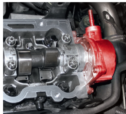
Вакуумный насос и распределительный вал в Opel Vectra B (выделено красным)
