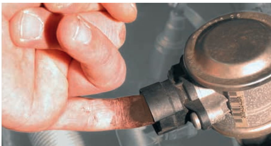
Быстрая проверка клапана вторичного воздуха BMW 520i (выделено)
