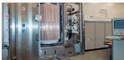
Technologia PVD: napyłanie katodowe (inaczej powlekanie magnetronowe).
