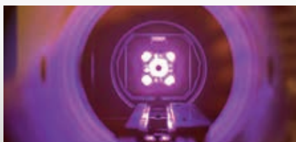
Wnętrze instalacji do metalizowania metodą napyłania katodowego: w warunkach wysokiej próżni najwyższa warstwa panewek łożyskowych jest uszlachetniana z użyciem jonów gazów.
