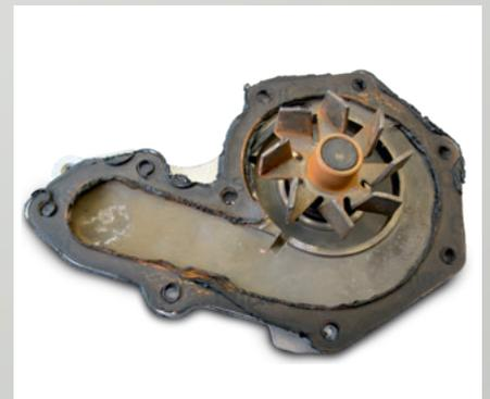
*Чрезмерное использование жидких уплотнительных средств (здесь: силикон)*
