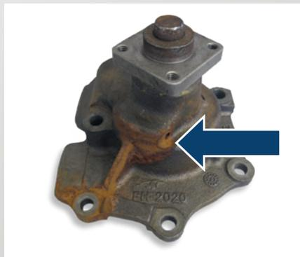
*Водяной насос, утративший герметичность из-за коррозионной охлаждающей жидкости (недостаточная защита от коррозии со стороны охлаждающей жидкости)*
