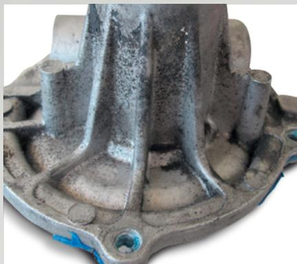
*Повреждение подшипников из-за проблем с ремнем (износ резины, частицы на корпусе)*
