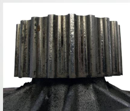
*Приводная шестерня, поврежденная грязью и износом (повреждение подшипников)*
