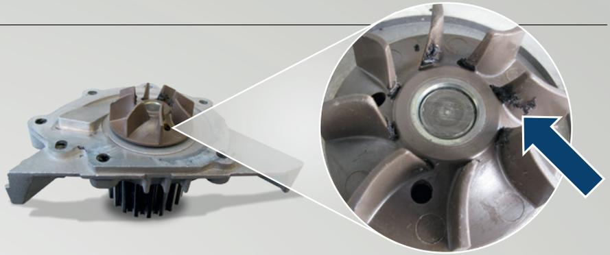
*Водяной насос, утративший герметичность из-за жидкого уплотнительного средства (насос стал негерметичным еще во время прогрева)*
