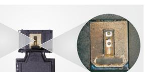
Sensore della massa dell'aria con depositi salini
