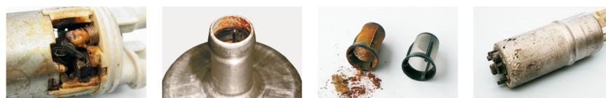
Danni da fusione in seguito a funzionamento a secco
