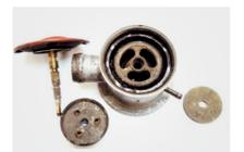
Valvola aria secondaria pneumatica: Danni dovuti alla condensa
