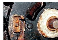
Pompa aria secondaria - collegamenti elettrici corrosi
