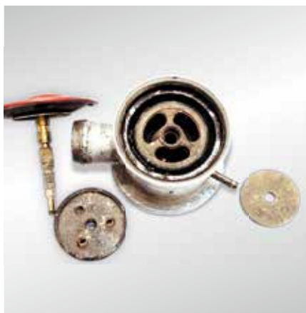
Fig. 30 Clapet anti-retour de coupure d'air secondaire – Dégâts de condensation sur les membranes et les têtes de soupape
