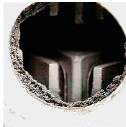
Fig. 31 Dépôts sur le clapet anti-retour
