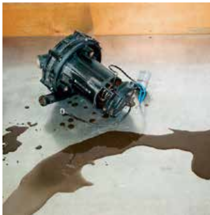
Fig. 28 Condensation dans la pompe d'air secondaire
