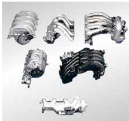
Fig. 43 Différents types de conduites d'aspiration
