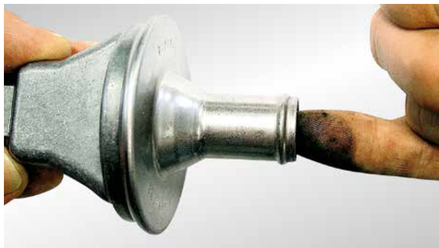
Fig. 32 Contrôle simple du clapet anti-retour
