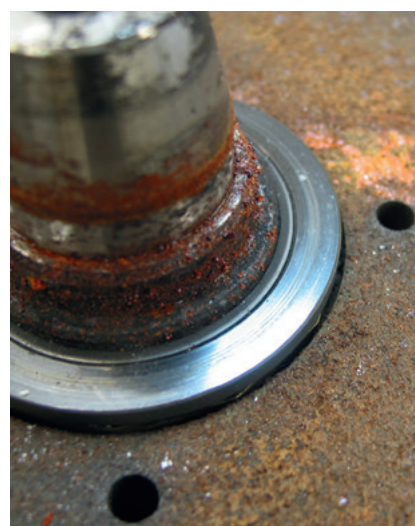
Guarnizione ad anello scorrevole distrutta – le superfici di scorrimento sono state rovinare da particelle estranee
