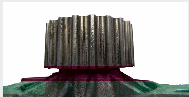
Ruota motrice danneggiata da sporcizia e usura (danni ai cuscinetti)
