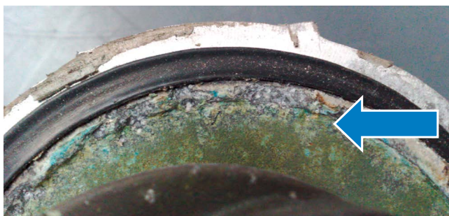
Il liquido di raffreddamento inadeguato ha causato corrosione e perdite
