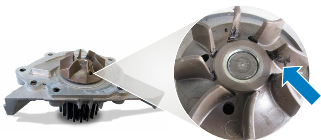
Perdite dalla pompa dell'acqua dovute al sigillante liquido (perdite dalla pompa durante il riscaldamento)
