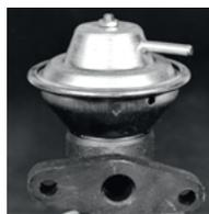
Разработка первых клапанов **рециркуляции отработанных газов (EGR)** от Pierburg
