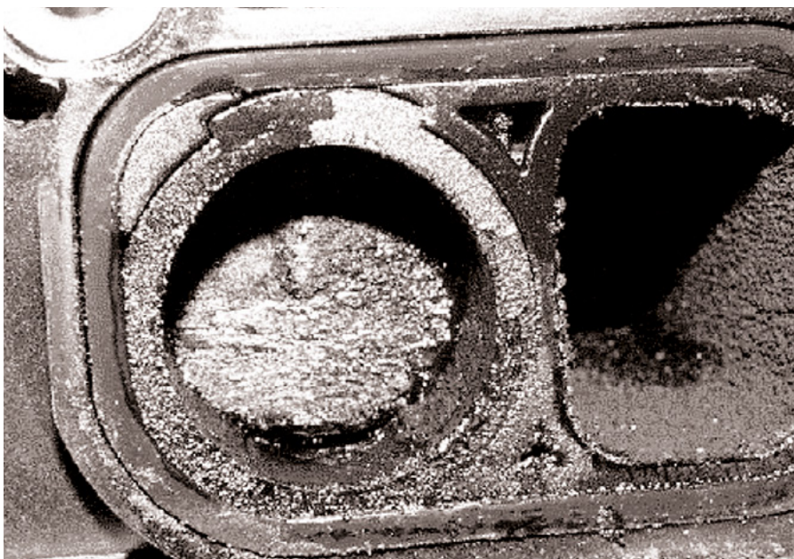
Tumbleklappen, ausgefallen wegen starker Ablagerungen
