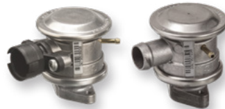
Sekundärluftventile, pneumatisch (ab ca. 1995) Pneumatische Sekundärluftventile, die durch Unterdruck betätigt werden, haben sich seit Jahrzehnten bewährt. Sie werden über ein Umschaltventil angesteuert.
