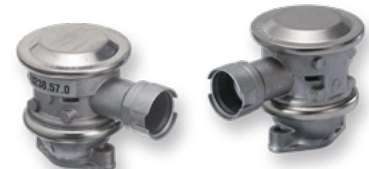
Sekundärluftventile, druckgesteuert (ab ca. 1998) Bei dieser Variante öffnet das Sekundärluftventil allein durch den Druck des Sekundärluftstroms – ein Umschaltventil zum Ansteuern entfällt.
