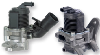
Sekundärluftventile, elektrisch (seit ca. 2007) Elektrische Sekundärluftventile bieten alle Voraussetzungen für eine Überwachung durch die On-Board-Diagnose (OBD). Sie verfügen über kürzere Öffnungs- und Schließzeiten als pneumatisch angesteuerte Ventile. Aufgrund höherer Stellkräfte sind sie resistenter gegen Verklebungen durch Ruß oder Schmutz.
