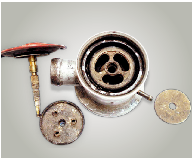
Ablagerungen am Rückschlagventil
