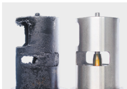
Válvula EGR presa (diesel) e no estado novo
