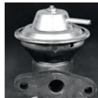
Sviluppo delle prime **valvole di ricircolo gas di scarico (EGR)** di Pierburg
