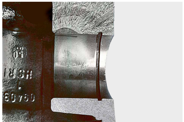
Fig. 3 : Vue en coupe d'un bossage d'axe de piston
