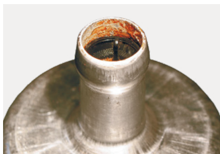
Entrada na bomba com ferrugem (danos causados pela água)
