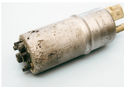
Corrosão por contacto
