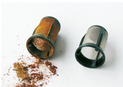
Filtro entupido e filtro novo
