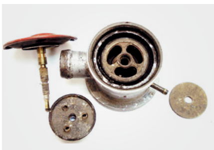
Válvula de ar secundário pneumática: Danos devido ao condensado
