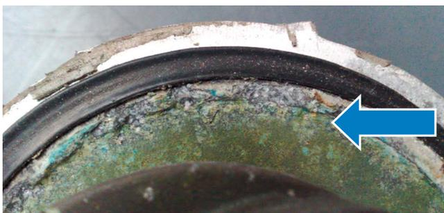
Un líquido refrigerante inadecuado ha provocado corrosión y fugas
