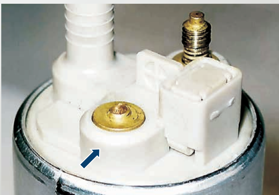
Abb. 75: Gewaltschaden an den elektrischen Kontakten
