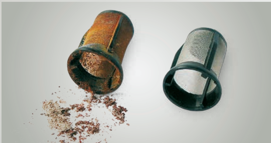
Abb. 41: links: durch Rost verstopfter Siebfilter; rechts: neuer Siebfilter
