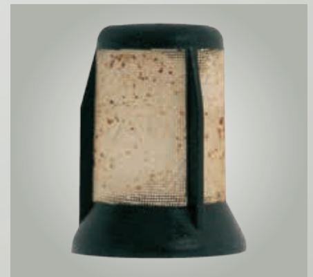
Abb. 23: verunreinigter Siebfilter einer Zahnringpumpe E3T
