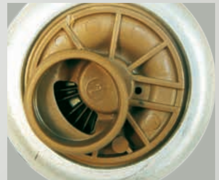
Abb. 35: Zum Vergleich: Blick in den Saugstutzen einer Seitenkanalpumpe mit unbeschädigtem Läuferad.
