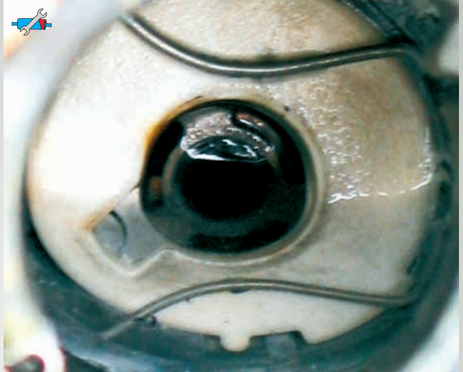
Abb. 44: Wasser in einer Kraftstoffpumpe
