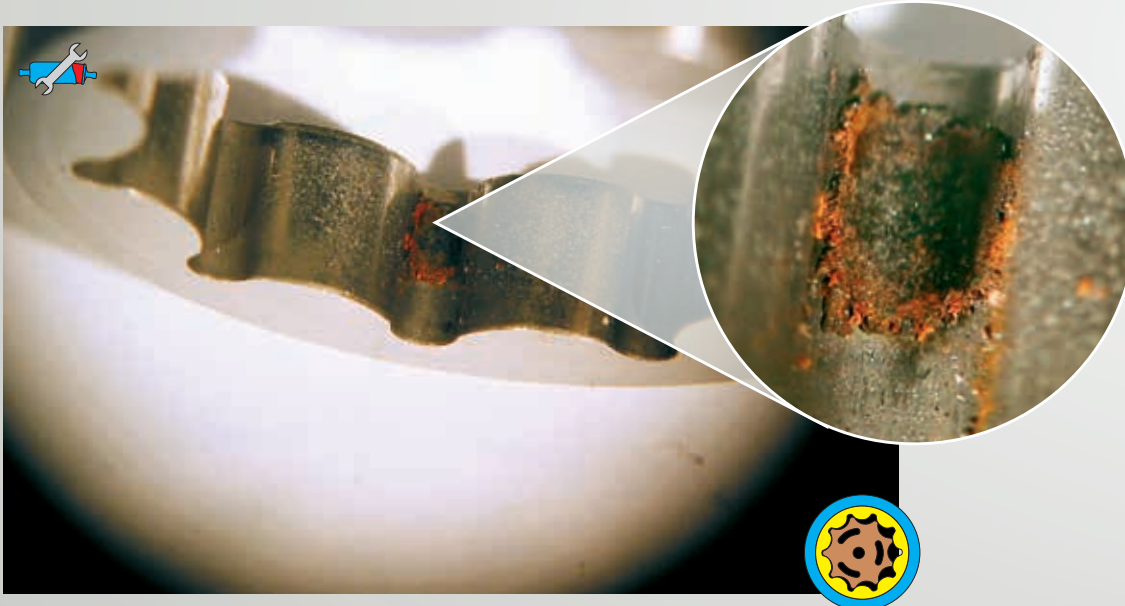
Abb. 47: Trochoiden-Zahnring blockiert durch Rostpartikel
