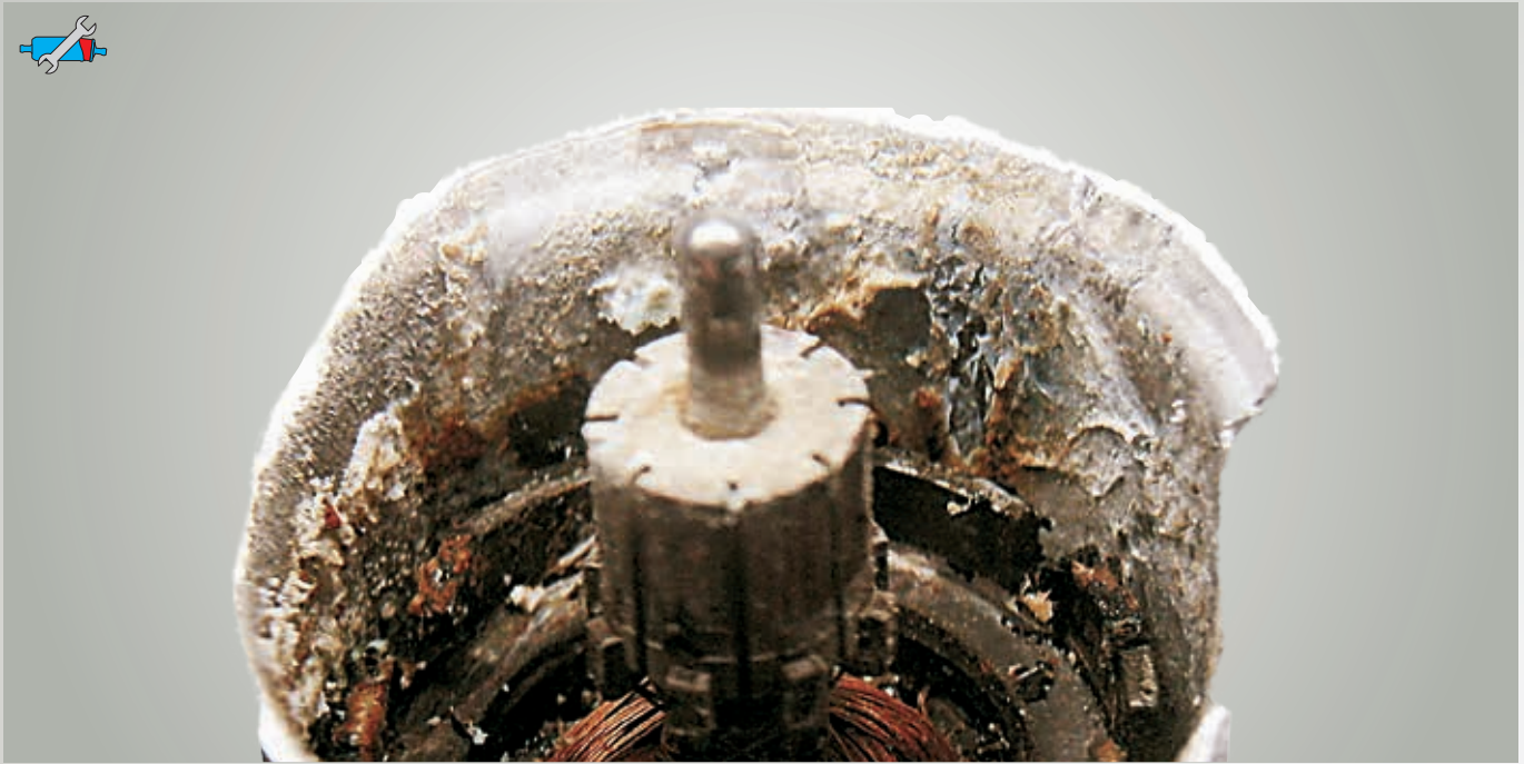
Abb. 16: Stark korrodierte elektrische Kraftstoffpumpe
