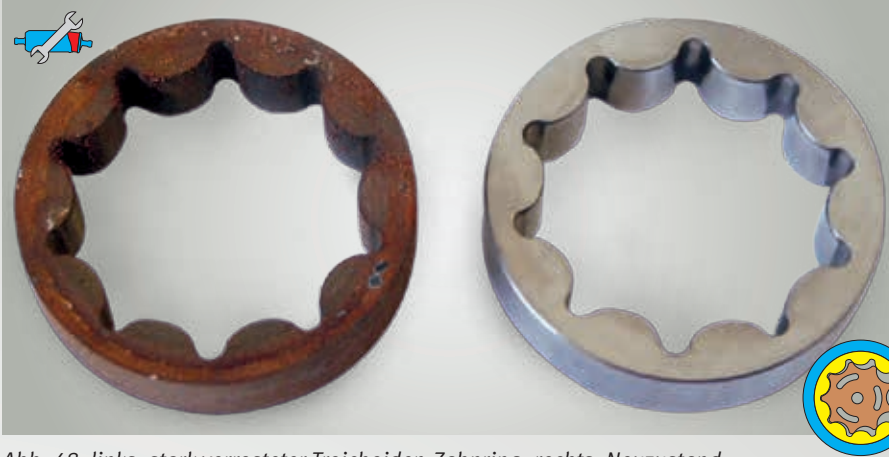
Abb. 48: links: stark verrosteter Trochoiden-Zahnring; rechts: Neuzustand
