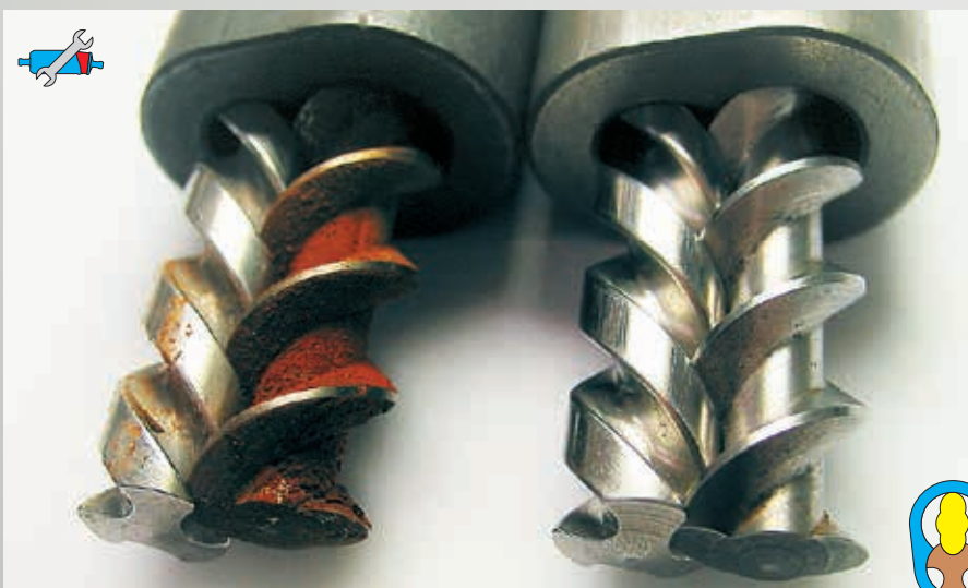
Abb. 54: Schraubenpumpe (links verrostet und rechts neu)
