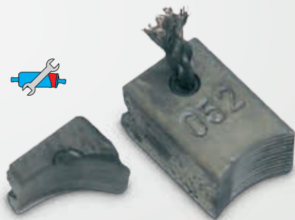
Abb. 62: Schleifkontakte bei ca. 15.000 km links: vorzeitig verschlissen; rechts: normaler Zustand bei dieser Laufleistung
