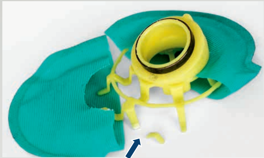
Abb. 76: Gebrochene Verstärkungsrippen im Filter einer In-Tank-Pumpe
