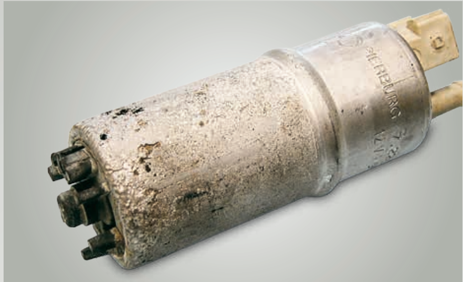
Abb. 72: Kontaktkorrosion durch falsche Materialpaarung
