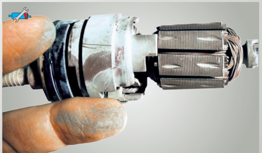
Abb. 56: Belag durch Kraftstoff in mangelhafter Qualität
