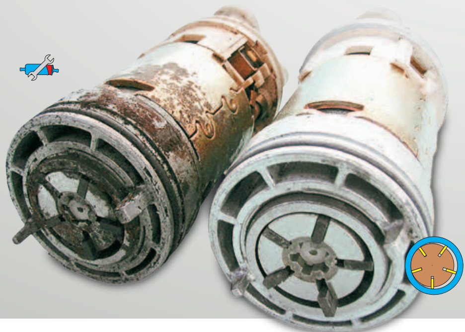
Abb. 36: Wasserschaden an Flügelzellenpumpe
