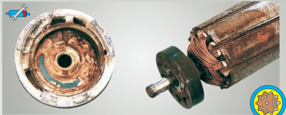
Abb. 37: Zahnringpumpe E3T – mit Rost- und Kalkablagerungen
