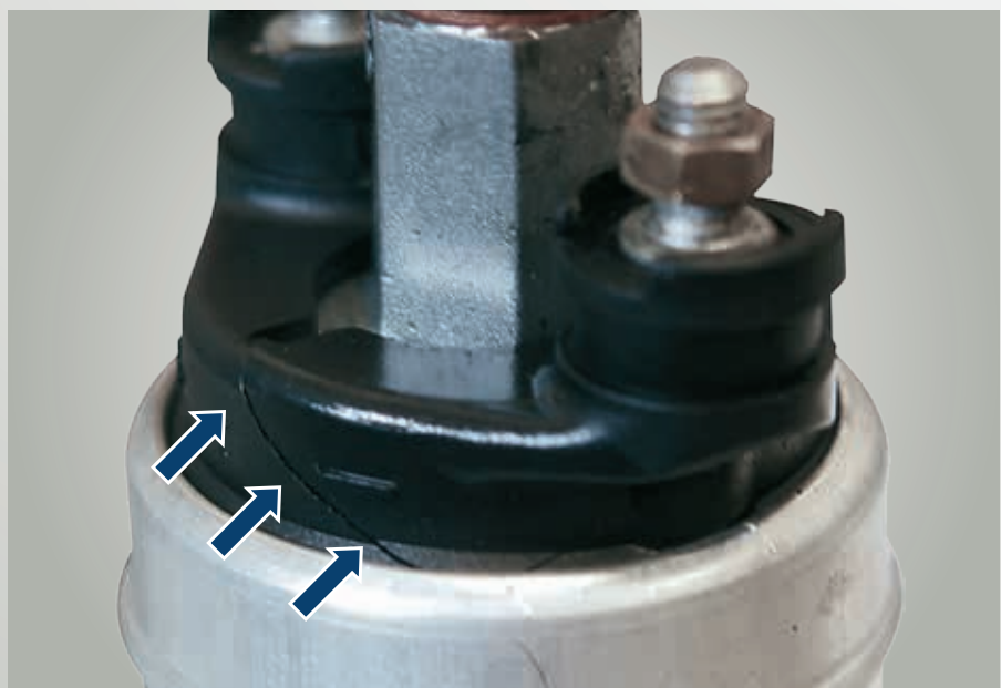
Abb. 73: Gewaltschaden am Gehäuse
