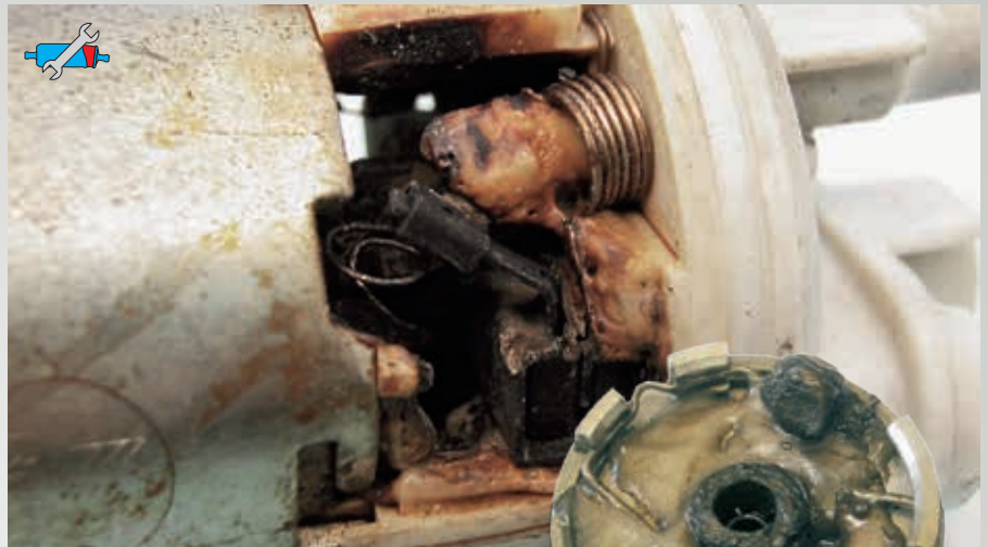
Abb. 20: Schmorschäden durch Trockenlauf
