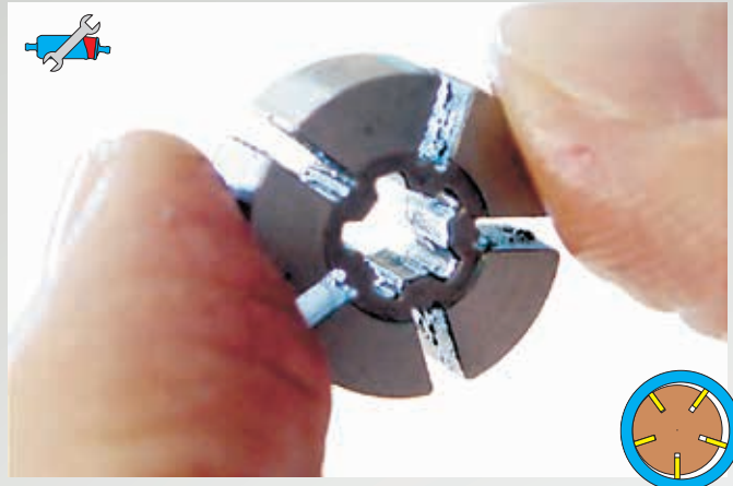
Abb. 30: verschmutztes Pumpenwerk einer Flügelzellenpumpe Der Rotor ist so verschmutzt, dass sich die einzelnen Flügel (hier entfernt) nicht mehr bewegen konnten. Die Pumpe „läuft“ zwar noch, fördert aber nicht mehr.
