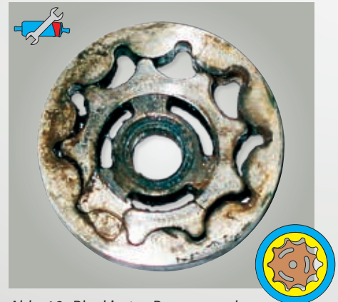
Abb. 19: Blockiertes Pumpenwerk (Trochoiden-Zahnring) einer Zahnringpumpe E3T
