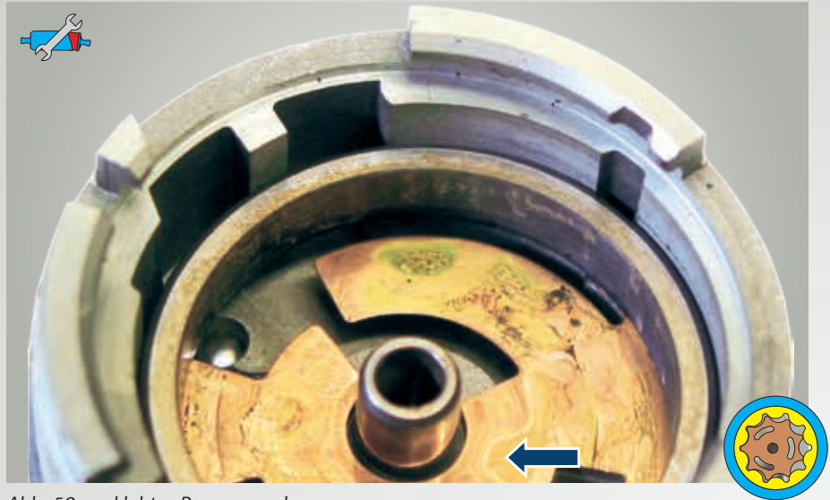
Abb. 59: verklebtes Pumpenwerk Die Laufscheibe war fest mit dem Trochoiden-Pumpenwerk verklebt. Das Pumpenwerk wurde für die Abbildung entfernt – seine Umrisse sind in der klebrigen Masse aber noch gut zu sehen.
