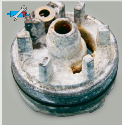
Abb. 50: verkalktes Außenlager einer Kraftstoffpumpe
