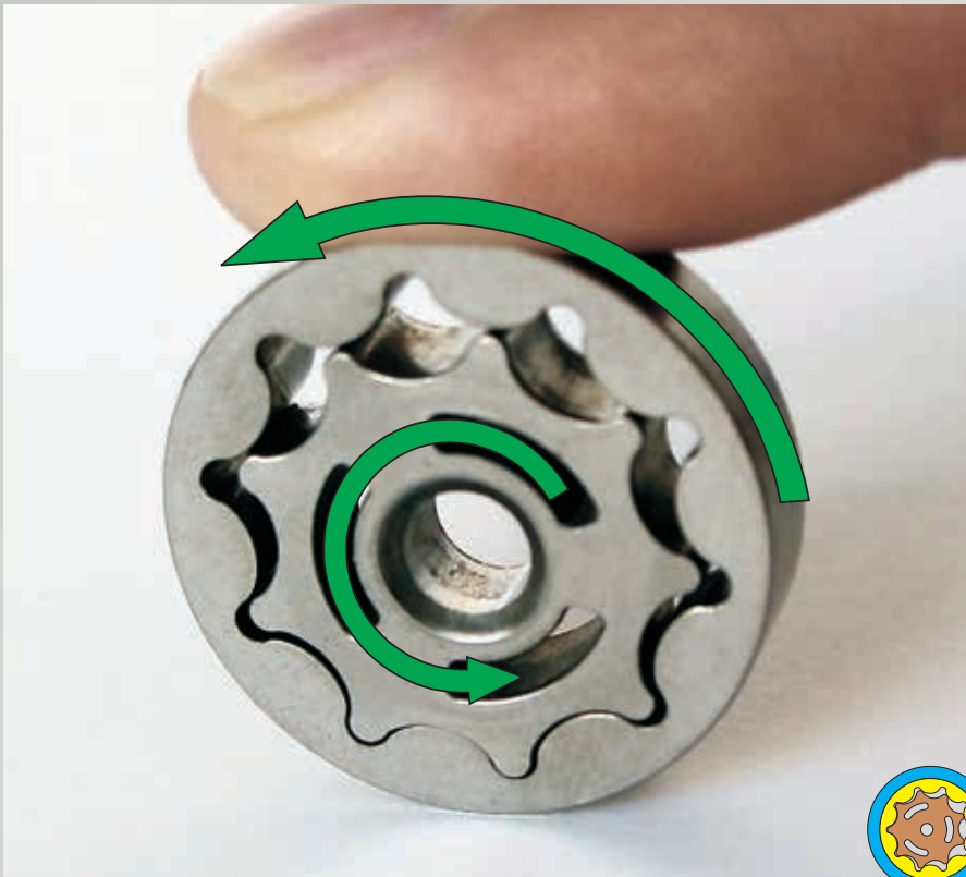
Abb. 52: Ein Trochoiden-Pumpenwerk muss leichtgängig ineinander abrollen.
