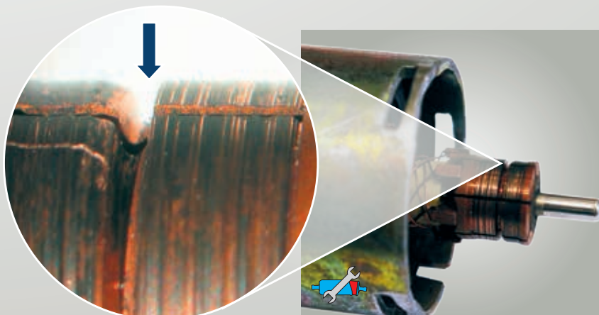
Abb. 62: Schleifkontakte bei ca. 15.000 km links: vorzeitig verschlissen; rechts: normaler Zustand bei dieser Laufleistung
