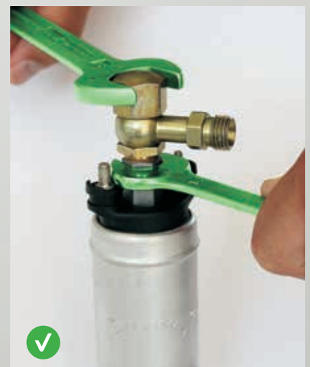
Abb. 71: richtige Montage: am unteren Sechskant der Kraftstoffpumpe muss gekontert werden
