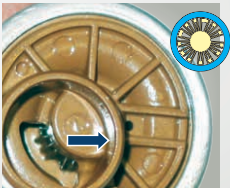
Abb. 34: Die Rippen des Läuferades einer Seitenkanalpumpe vom Typ E1S wurden von einem Fremdkörper zerstört (links).
