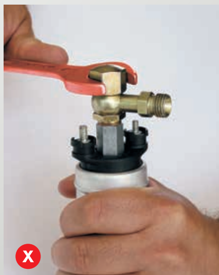
Abb. 70: falsche Montage: Festziehen ohne Kontern
