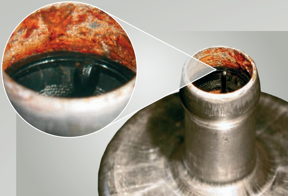
Abb. 40: verrosteter Einlauf einer Flügelzellenpumpe E1F
