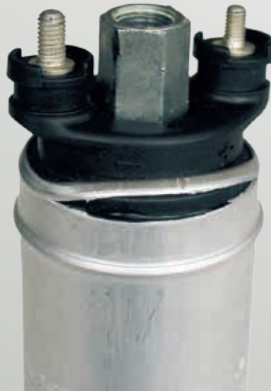
Abb. 1: Gewaltschaden Nicht immer ist ein Schaden so offensichtlich.
