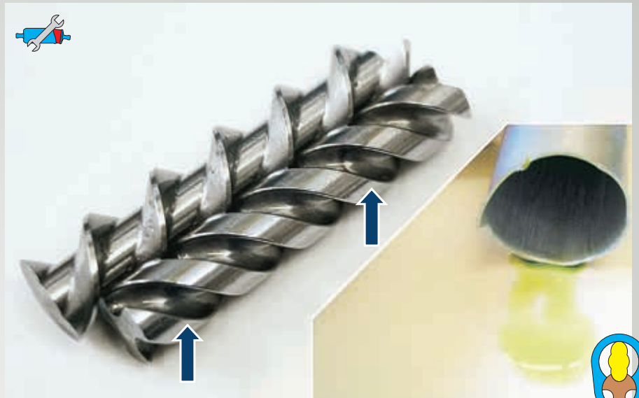
Abb. 55: Verklebungen durch unzulässiges Medium
