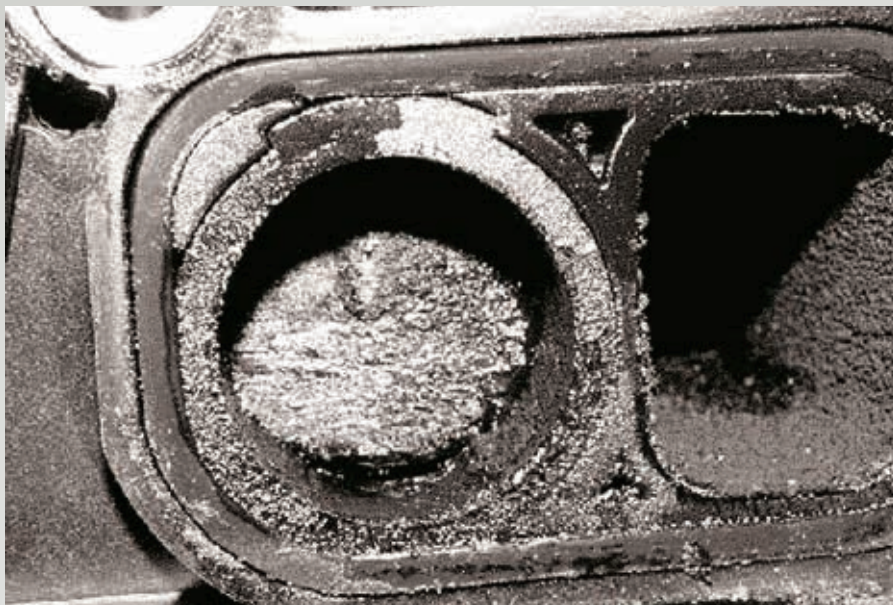
Fig. 44: Válvulas de turbulencias, fallo debido a gran acumulación de sedimentos
