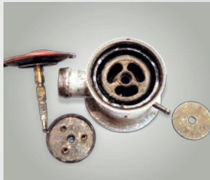
Fig. 30: Válvula de retención desconectable, daños en la membrana y el platillo de la válvula debido a condensado
