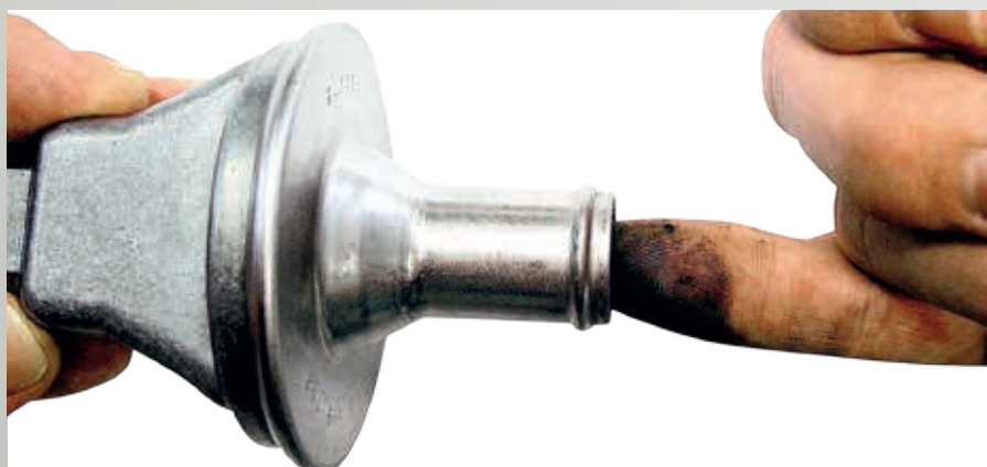
Fig. 32: Sencilla comprobación de la válvula de retención
