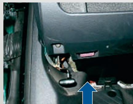
Fig. 9: Ejemplos de lugares de montaje para cajas de enchufe para diagnóstico
