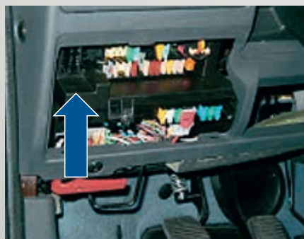
Fig. 9: Ejemplos de lugares de montaje para cajas de enchufe para diagnóstico
