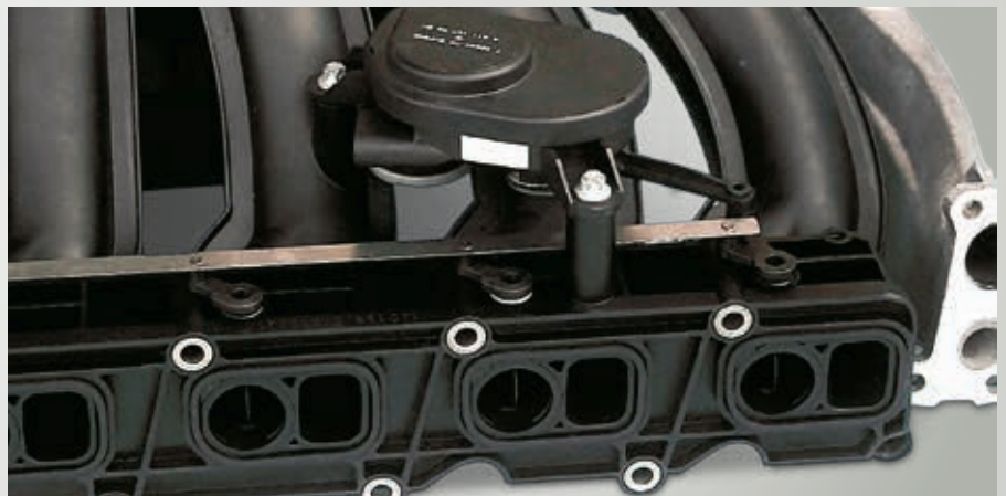
Fig. 41: Tubería de aspiración con válvulas de turbulencias y EAM-i
