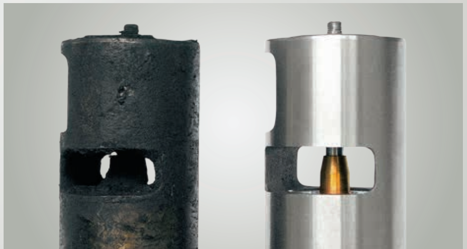
Fig. 38: Válvula EGR (diésel) con sedimentos importantes y en estado nuevo
