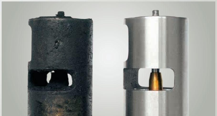
Abb. 38 AGR-Ventil (Diesel) mit starken Ablagerungen und im Neuzustand
