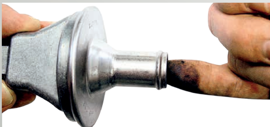
Abb. 32 Einfache Prüfung des Rückschlagventils
