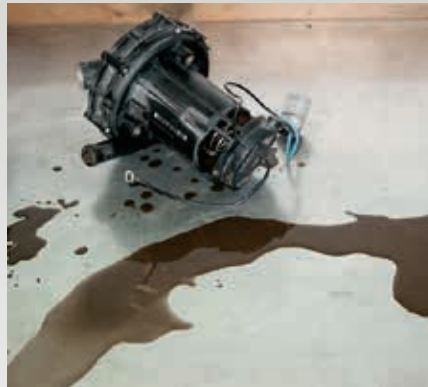
Abb. 28: Kondensat in der Sekundärluftpumpe
