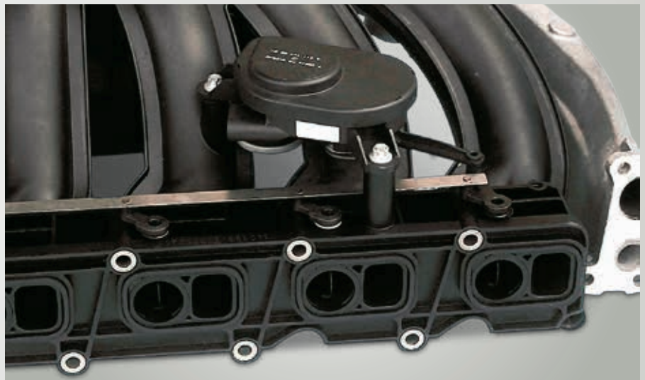
Abb. 41 Saugrohr mit Tumbleklappen und EAM-i
