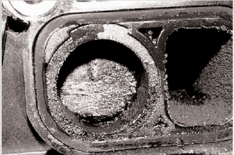
Abb. 44 Tumbleklappen, ausgefallen wegen starker Ablagerungen
