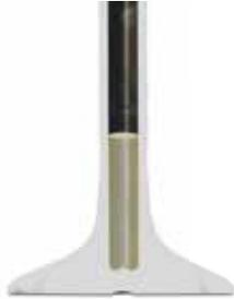
As válvulas ocas com preenchimento de sódio melhoram o transporte do calor em motores sujeitos a cargas elevadas. O sódio liquefaz-se à temperatura de funcionamento e transporta o calor do prato da válvula para a haste da válvula, onde pode ser passado para a guia de válvula.
