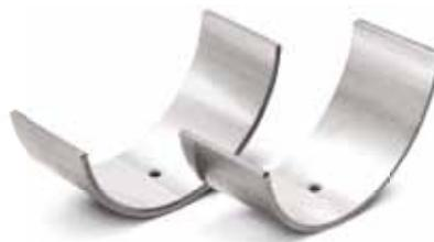
As capas de bronzina sem ressalto de fixação facilitam a montagem à máquina dos motores no fabricante. O ressalto de fixação não é necessário para a correcta função de apoio da bronzina.
