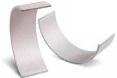
Nas bronzinas trimetais, o metal do apoio (liga de bronze) é fundido ou sinterizado sobre a base em aço.
