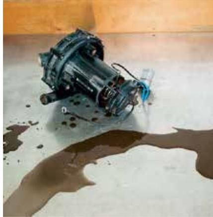
Fig. 28 Condensation dans la pompe d'air secondaire
