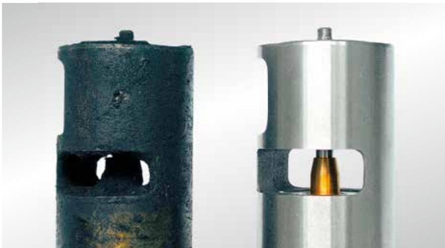
Fig. 38 Valve EGR (diesel) avec d'importants dépôts et à l'état neuf
