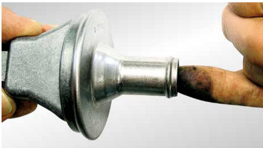
Fig. 32 Contrôle simple du clapet anti-retour
