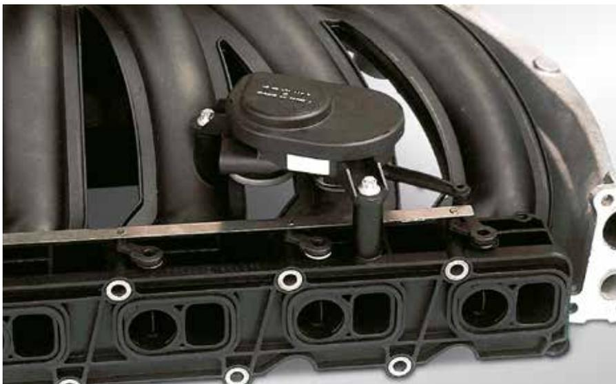
Fig. 41 Collecteur d'aspiration avec clapets « Tumble » et EAM-i
