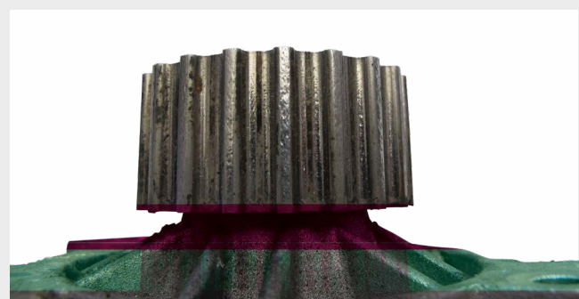
Roda motriz danificada por sujidade e desgaste (danos nos rolamentos)
