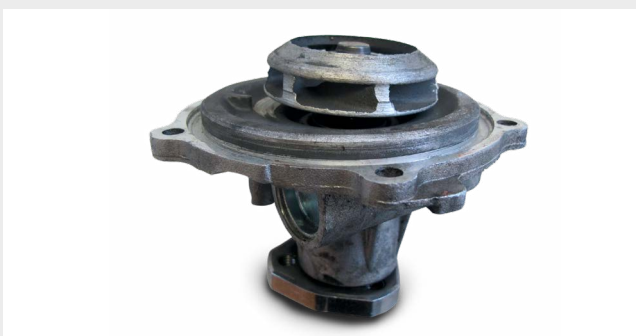
Danos nos rolamentos devido a tensão excessiva da correia
