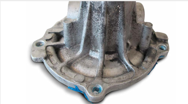
皮带问题造成的轴承损伤（橡胶磨损，壳体上颗粒）
