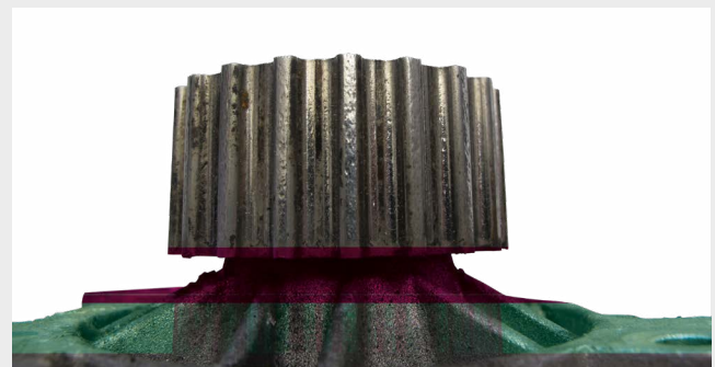
由于脏污和磨损造成的驱动轮损伤（轴承损伤）
