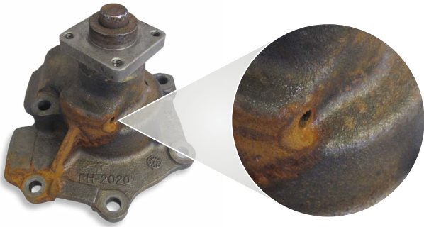
Paslı soğutma maddesi nedeniyle sızdıran su pompası (soğutma sıvısında eksik korozyon koruması)
