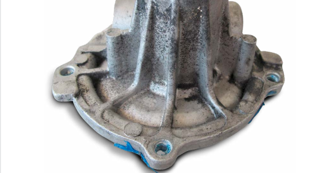
Kayış sorunları nedeniyle yatakların hasar görmesi (kauçuk aşınması, gövde üzerinde parçacıklar)
