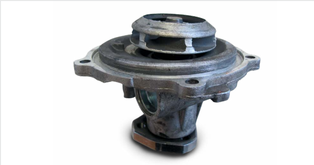
Yüksek kayış gerginliği nedeniyle yataklarda hasar
