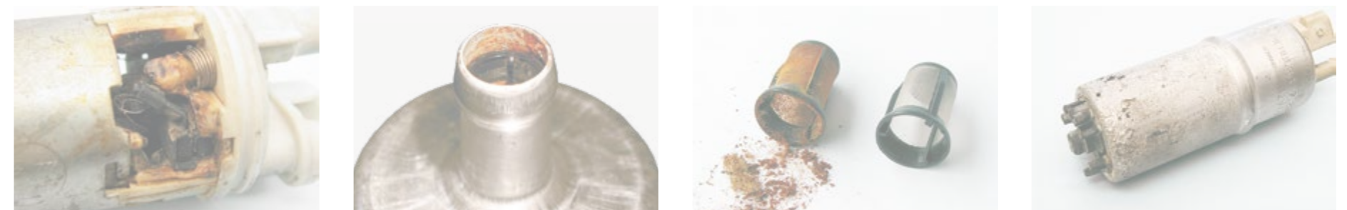
Schmerschaden durch Trockenlauf
