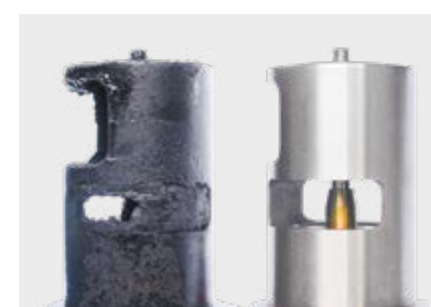
Valvola EGR incollata (motore diesel) e nello stato a nuovo
