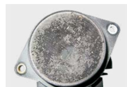
Débitmètre d'air massique (LMS) bouché
