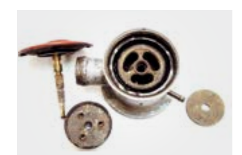
Pneumatisches Sekundärluftventil: Schäden durch Kondensat
