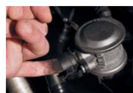
Einfache Prüfung des Sekundärluftventils
