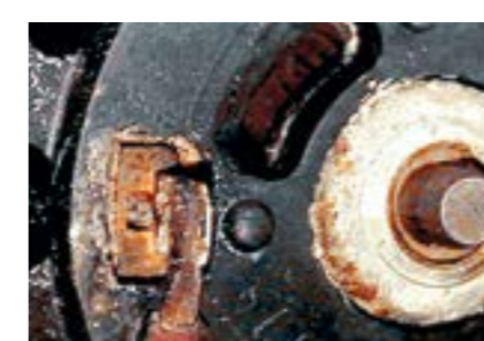
Sekundärluftpumpe – korrodierte elektrische Anschlüsse
