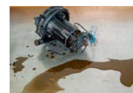
Kondensat in der Sekundärluftpumpe
