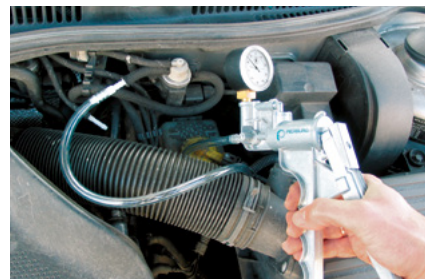
I componenti pneumatici possono essere controllati facilmente con attrezzi semplici.
