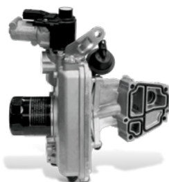
Integrazione crescente: modulo radiatore EGR con radiatore olio e filtro dell'olio in un unico componente
