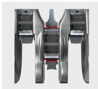
Рис. 2: выпуклое отверстие под подшипник
