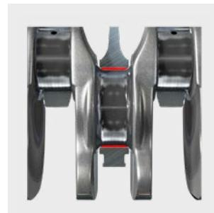
Рис. 3: слишком большой радиус закругления
