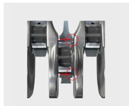
Рис. 3: радиус закругления слишком велик с одной стороны
