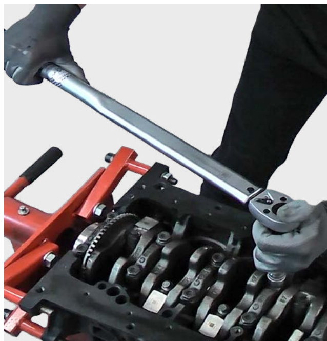
Serrage des vis selon les instructions du constructeur
