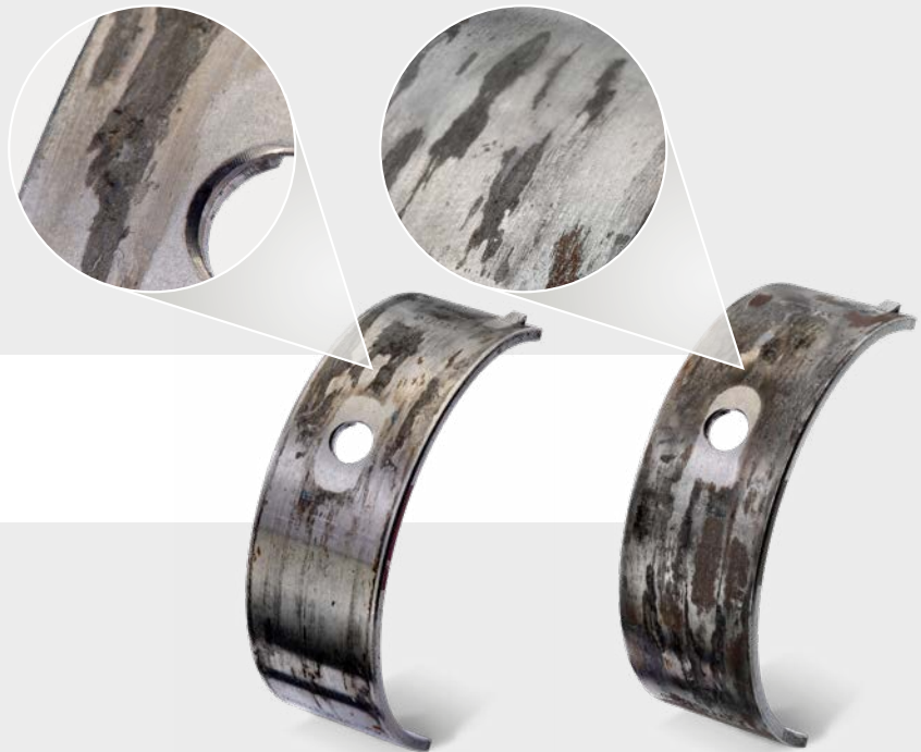
Fig. 2 : Zones d'arrachement partiel du matériau
