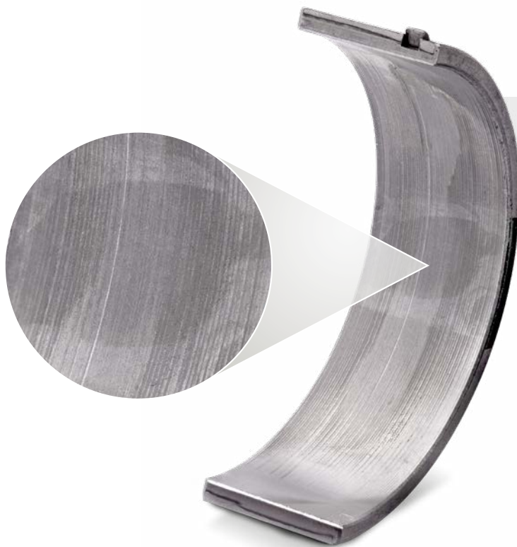
Coquille de coussinet de ligne inférieure en matériau composite acier-aluminium
