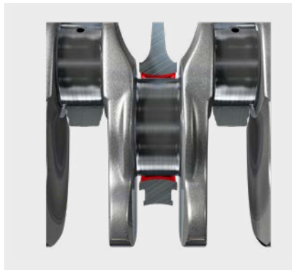
Fig. 2 : Alésage du logement convexe
