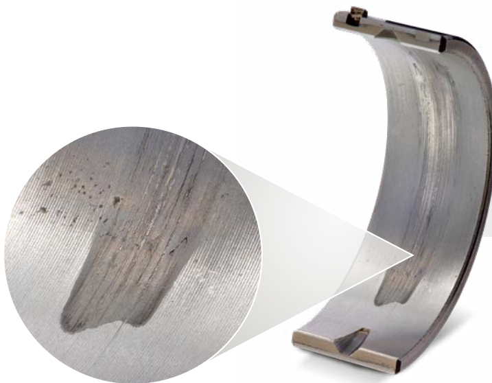
Coquille de coussinet de ligne inférieure en matériau composite acier-aluminium
