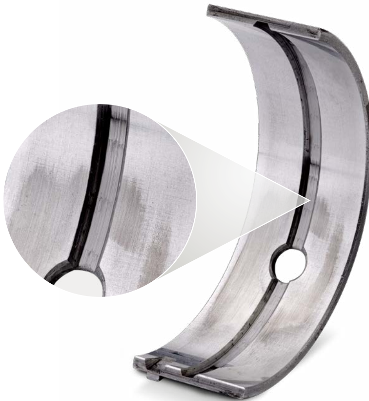
Coquille de coussinet de ligne supérieure en matériau composite acier-aluminium
