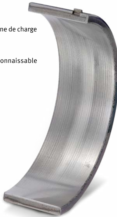
Coquille de coussinet de ligne inférieure en matériau composite acier-aluminium (sans revêtement)
