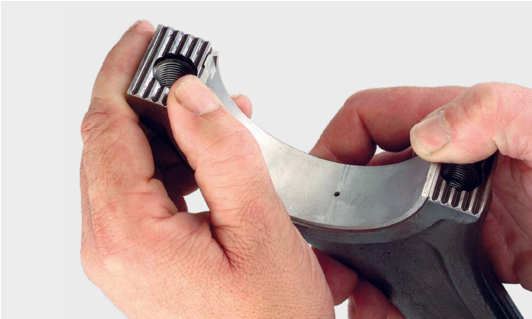
Documenter le siège et la position des coussinets
