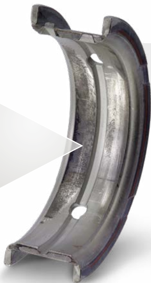
Coquille de coussinet de ligne en matériau composite acier-bronze avec revêtement galvanisé
