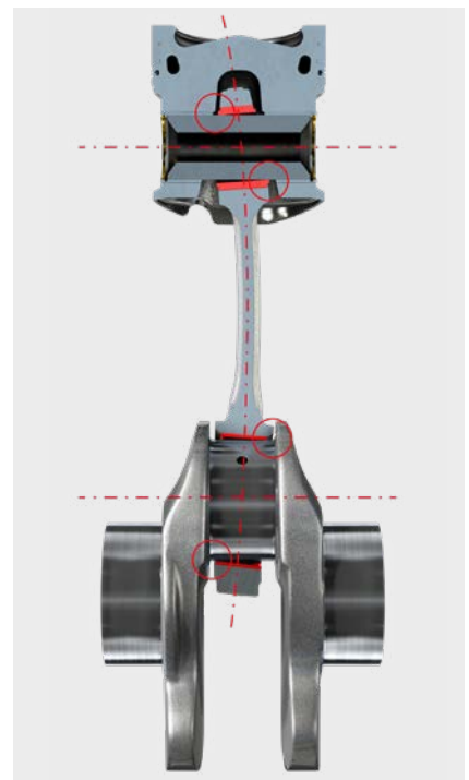
Fig. 2 : « Vacillement » de la tige de bielle
