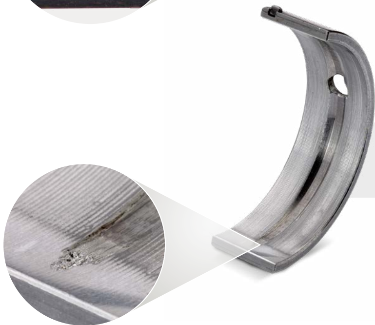
Coquilles de coussinet de ligne supérieures en matériau composite acier-aluminium
