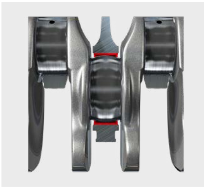
Fig. 1 : Forme trop convexe du maneton
