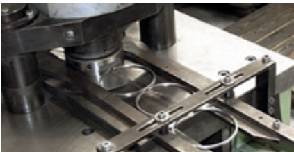
İçten tornalama makinesi – İç kontürün üretimi
