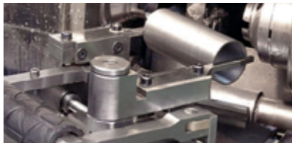
Piston segmanı çalışma yüzeyinin taşlanması
