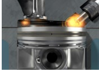
Vuruntulu yanma (detonasyon)
