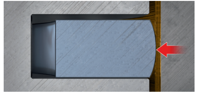
Şek. 2: Simetrik ve yuvarlak segman çalışma yüzeyi
