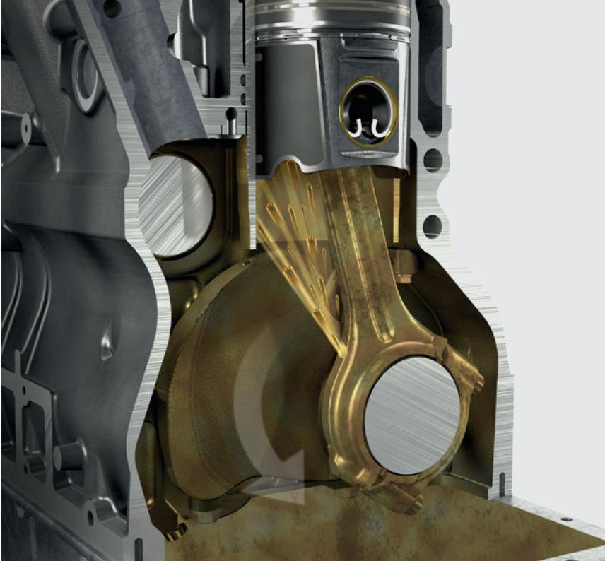
Şek. 1: Biyeldeki yağ sıçratma delikleri, çalışma yüzeyinin yağlanmasını garanti eder
