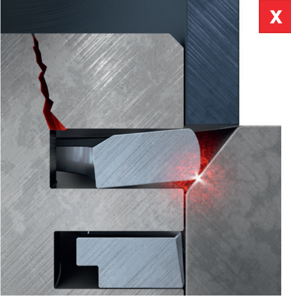
Şek. 1: Silindir deliğinde çok fazla kenar pahı – Piston segmanı montaj sırasında piston segmanı sıkıştırma bandı ile silindir arasında yaylanır ve piston bloke olur
