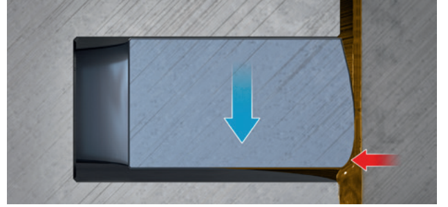
Şek. 5: Aşağı hareket sırasındaki hafif süzülme
