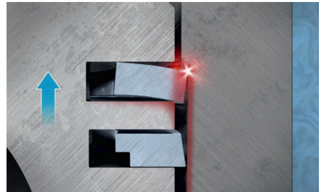
Şek. 3: Yeni pistonda piston segmanı çarpması
