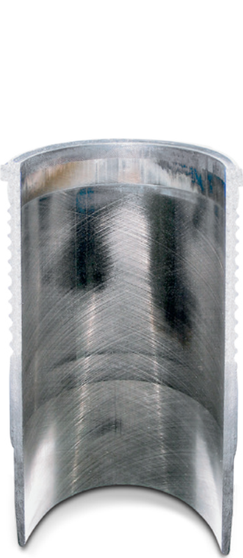
Şek. 2: Üst silindir bölgesindeki parlak kısımlar ve perdah yerleri
