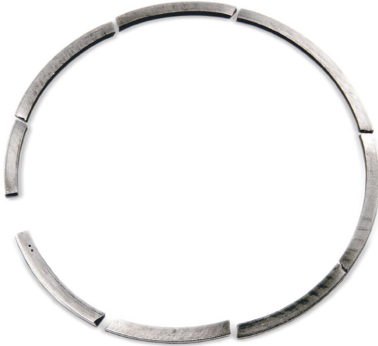
Kırılmış piston segmanı
