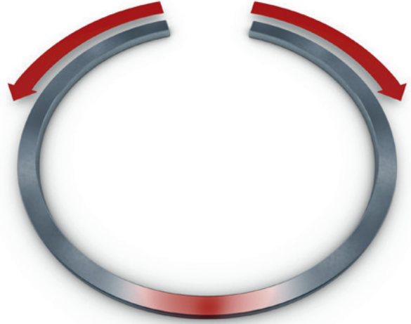
Şek. 1: Piston segmanının pistonun üzerine aşırı çekilmesi
