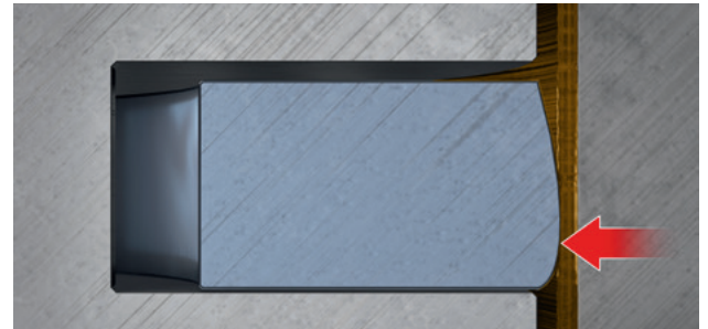
Şek. 3: Asimetrik ve yuvarlak segman çalışma yüzeyi
