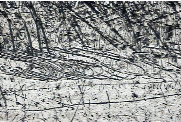
Şek. 4 ve 5: Üst segman kenarındaki yuvarlanma izlerine örnekler
