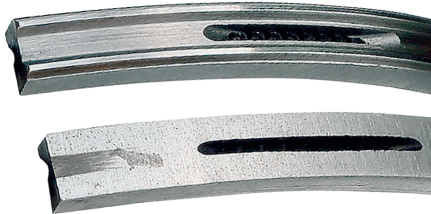
Şek. 3: Yeni ve aşınmış yağ sıyırma segmanı
