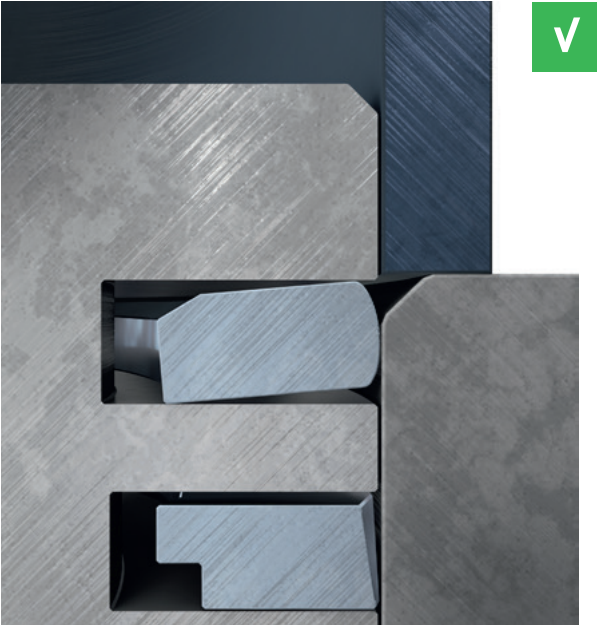
Şek. 2: Silindir deliğinde az kenar pahı – piston segmanı boşluk üzerinde kayar
