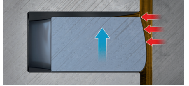
Şek. 4: Yukarı hareket sırasındaki kuvvetli süzülme
