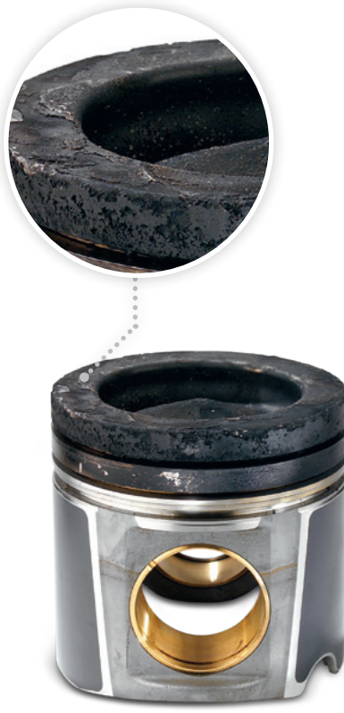
Şek. 3: Yanma yolundaki yağ karbon tabakası
