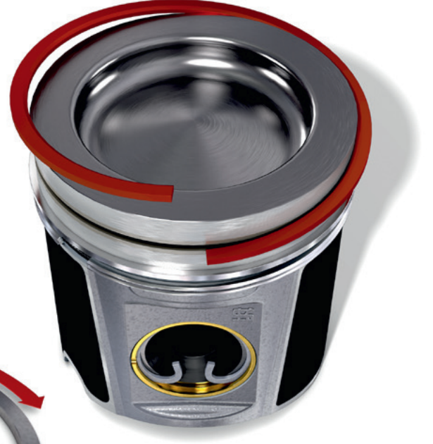
Şek. 1: Piston üzerine çekme sırasında piston segmanlarının dönmesi ve açılması
