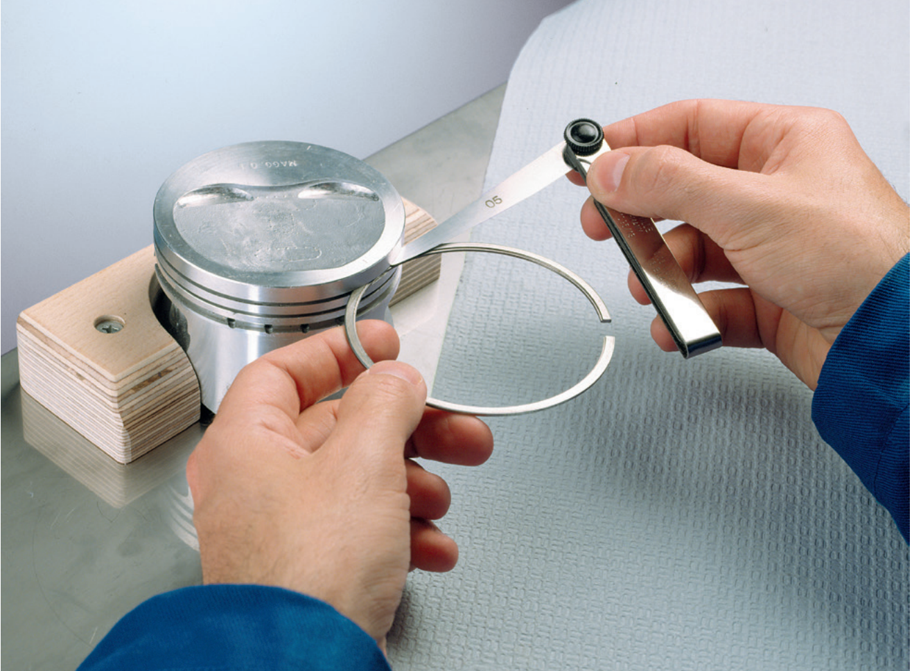
Şek. 1: Segman yüksekliği boşluğunun ölçülmesi
