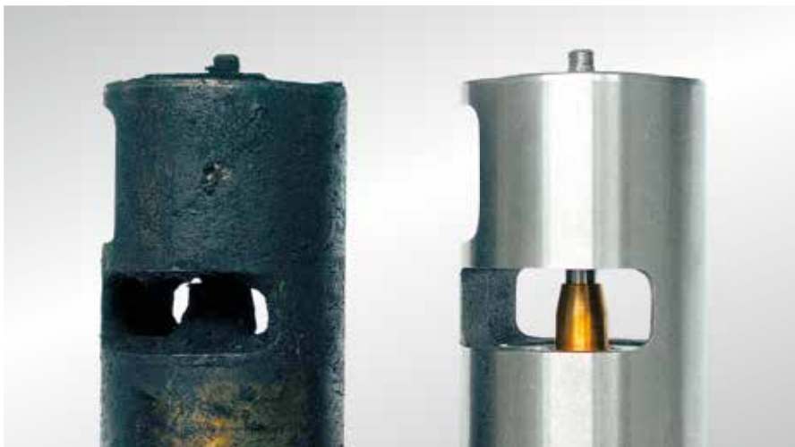
Рис. 38 Клапан системы EGR (дизель) с сильными отложениями и в новом состоянии
