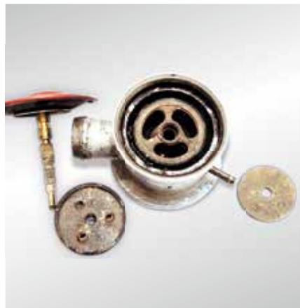
Рис. 30 Отключаемый обратный клапан – повреждения мембраны и головки клапана под действием конденсата
