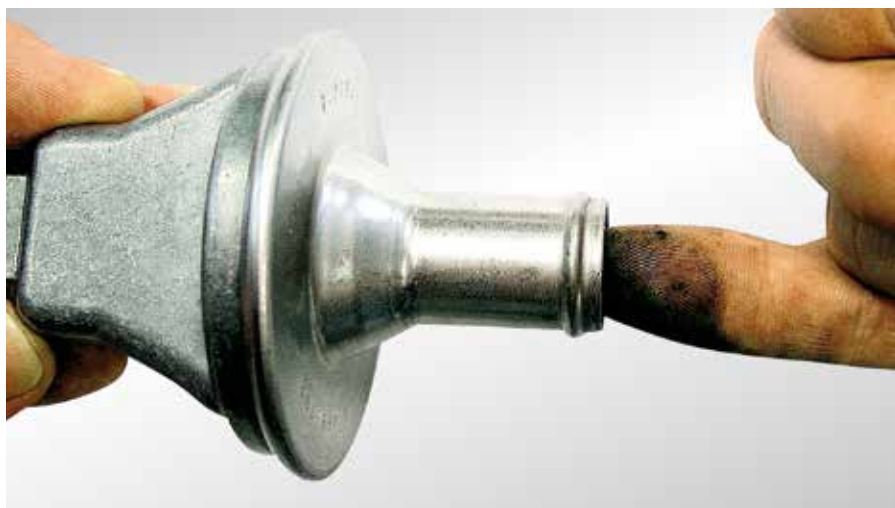
Рис. 32 Простая проверка обратного клапана
