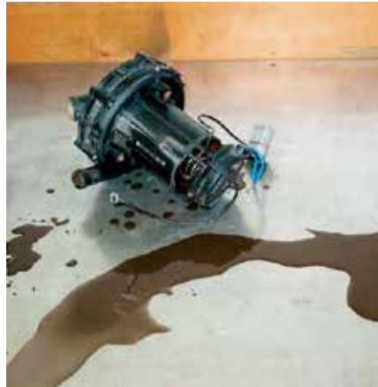
Рис. 28 Конденсат в насосе вторичного воздуха
