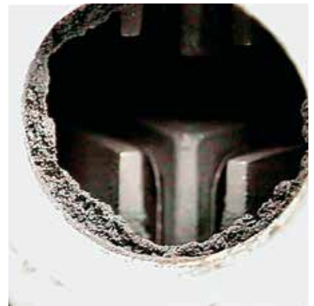
Рис. 31 Отложения на обратном клапане
