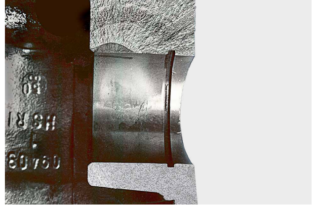
Şek. 3: Bir piston pimi göbeğinin kesiti
