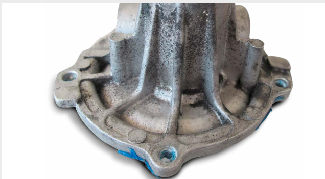
Danni ai cuscinetti dovuti a problemi del nastro (abrasione della gomma, particelle sull'alloggiamento)
