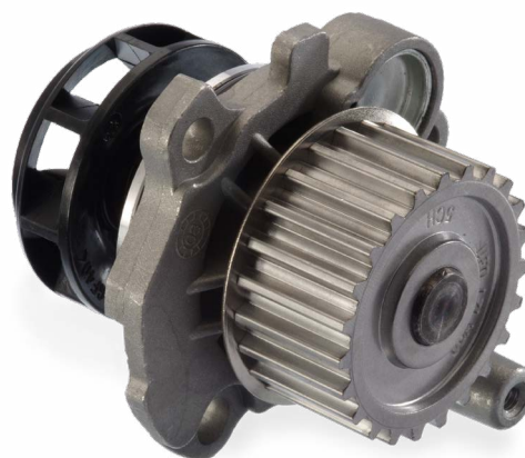
Pompa flangiata con trasmissione a cinghia dentata
